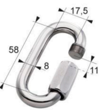
CMU : 700 kg Acier zingué Coef. sécu. 1/5 Poids : 0,078 kg
