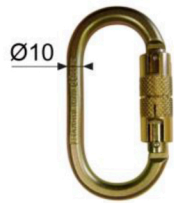
5266AZ011T acier zingué ouverture 18mm 110 x 60mm, 180 gr.
