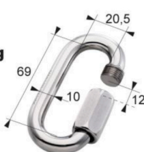
CMU : 1100 kg Acier zingué Coef. sécu. 1/5 Poids : 0,14 kg
