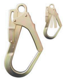
3805C acier zingué Spécial échafaudage à verrouillage automatique double-action ouverture 55mm 214 x 127mm, 510 gr. Résistance 23kN (2345kg)
