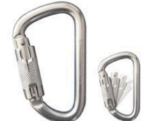
3805B aluminium ouverture 22mm 111 x 67,5mm, 90 gr. Résistance : 20kN (2039kg)
